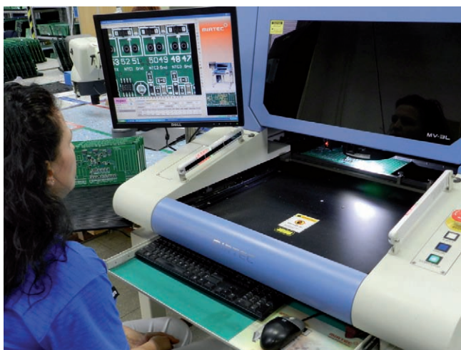
Obr. 3 Moderný systém na automatickú optickú kontrolu stráži kvalitu výstupu z výroby
