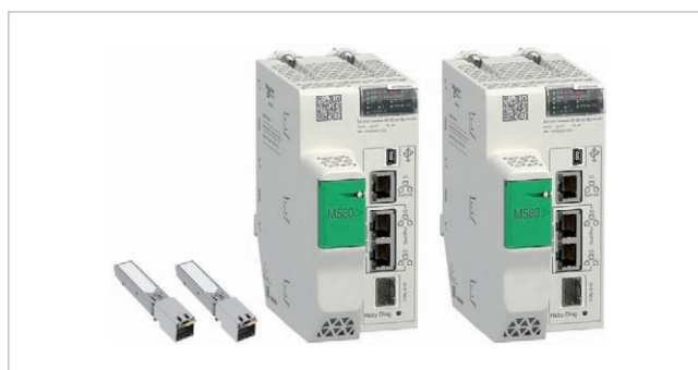
Obr. 2 Redundantné procesory Modicon M580 s integrovaným komunikačným portom (HSBY diag) vrátane prevodníka pre optiku
